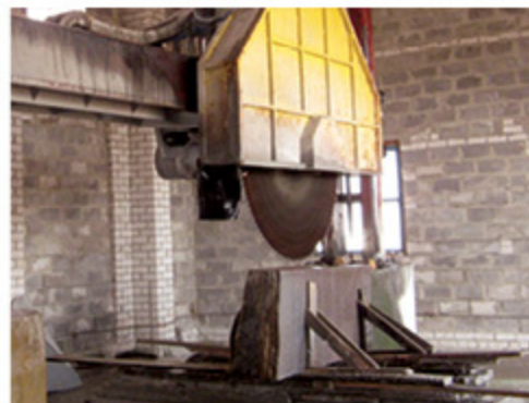
ПРОЦЕСС РАСПИЛОВКИ КАМЕННОГО БЛОКА НА СЛЗБЫ PROCESS OF SAWING A STONE BLOCK ON THE SLABS
