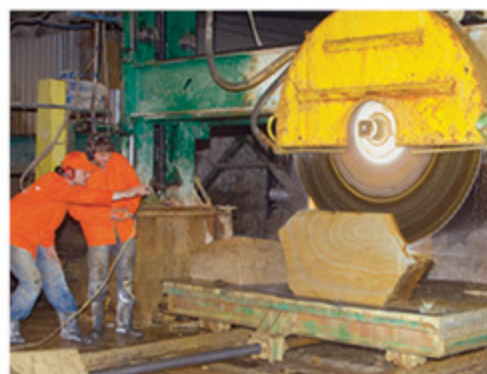
ПРОЦЕСС РАСПИЛОВКИ КАМЕННОГО БЛОКА НА СЛЭБЫ PROCESS OF SAWING A STONE BLOCK ON THE SLABS
