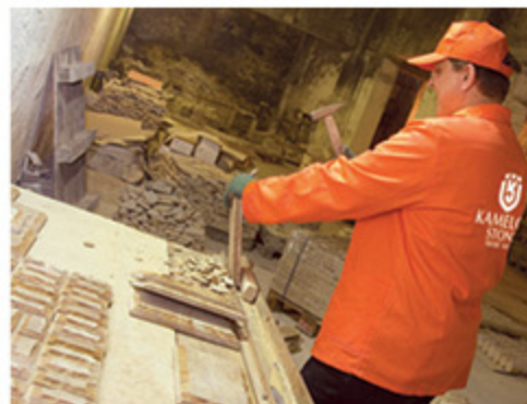
ТЕХНОЛОГИЧЕСКАЯ ОПЕРАЦИЯ - РУЧНОЙ СКОЛ TECHNOLOGICAL OPERATION - MANUAL CHIPPING
