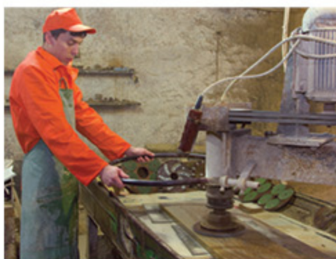
ПОЛИРОВКА РЕЗАННЫХ ПЛИТ РАЗНЫХ РАЗМЕРОВ POLISHING OF SLICED PLATES OF DIFFERENT SIZES
