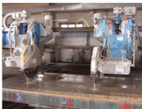
ПРОЦЕСС РЕЗКИ БРУСЧАТКИ PROCESS OF CUTTING SETT
