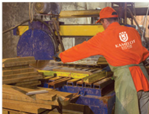
ПРОЦЕСС РАСПИЛОВКИ НА ПЛИТЫ РАЗНЫХ РАЗМЕРОВ PROCESS OF SAWING TO SLABS OF DIFFERENT SIZES
