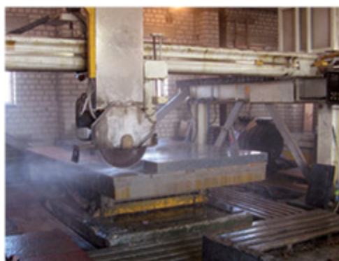
ПРОЦЕСС РАСПИЛОВКИ СЛЗБА SAWING A STONE BLOCK INTO SLASS
